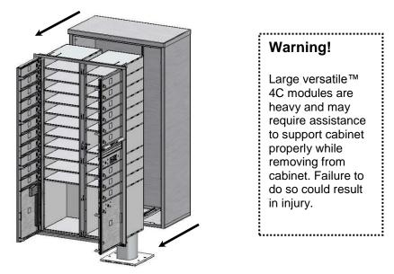
Figure 13 – Removing versatile<sup>TM</sup> 4C Module
